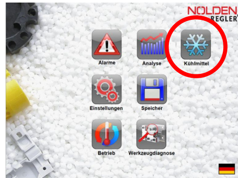
Kühlmittel-Überwachung auf dem „Homescreen“ des Regelgerätes
