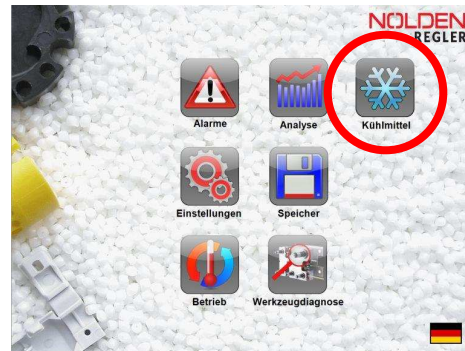
Kühlmittel-Überwachung auf dem „Homescreen“ des Regelgerätes
