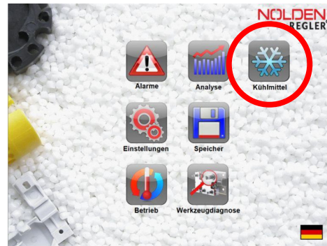
Fig.: Appli de surveillance de refroidissement sur le „Homescreen“ du système
