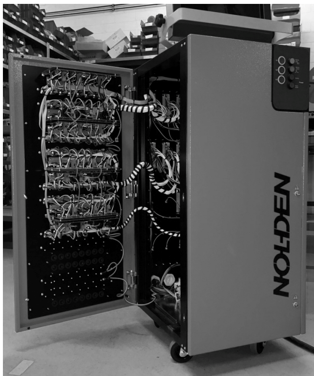
Fig.: Porte latérale NR 8056 ouverte avec Électronique de puissance
